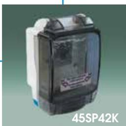
L'installazione da incasso si ottiene grazie alla piastra adattatrice cod. 45STPK che consente di adattare il coperchio AVE SEAL 2 moduli su scatole rettangolari 3 moduli standard con interasse 83,5 mm.
