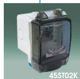
L'installazione lungo il palo è ottenuta grazie all'accessorio cod. BG101AP il quale consente di applicare il contenitore AVE SEAL 2 moduli direttamente su pali con diametro 35/40 mm fino a 55/60 mm
